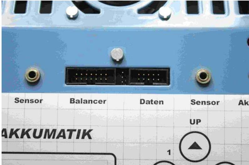
Mit internem Balancer/Equalizer gibt es oben am Gehäuse von links nach rechts diese Anschlüsse:
